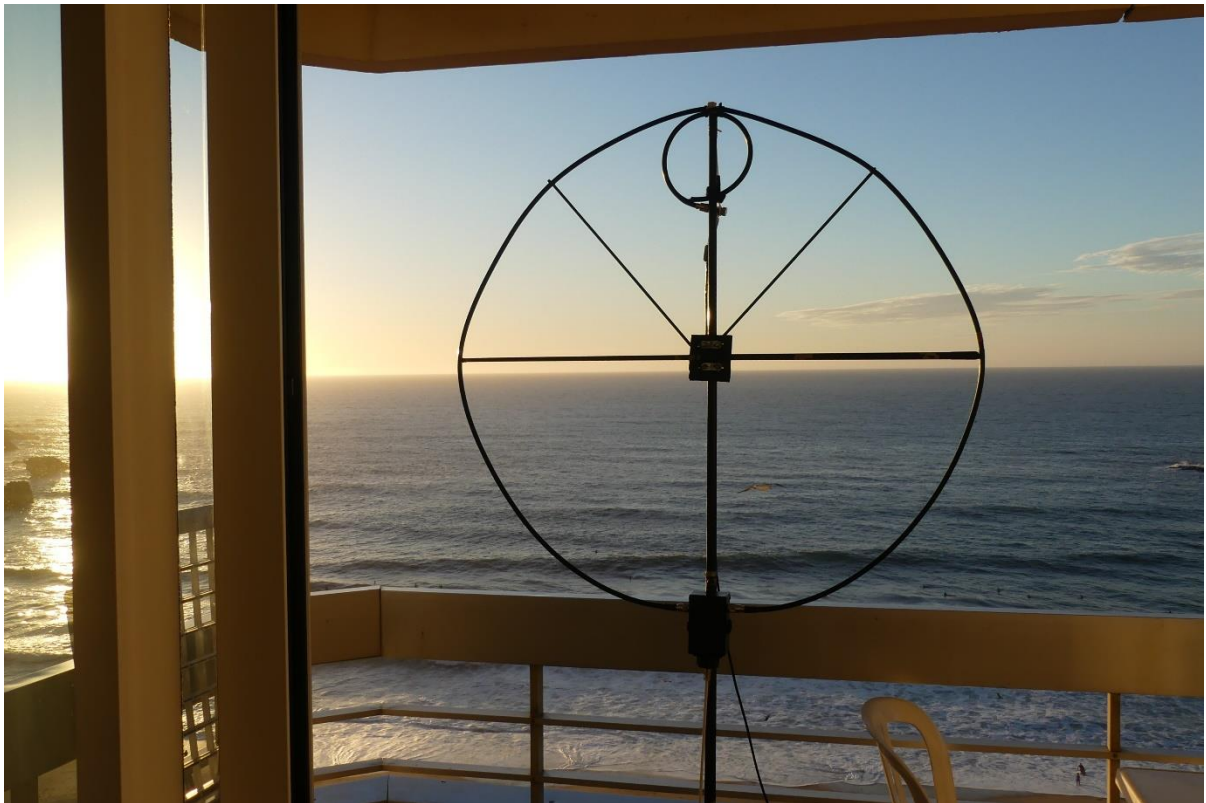
/P64 BIARRITZ (Boucle de 1m sur balcon avec environnement alu et béton)
