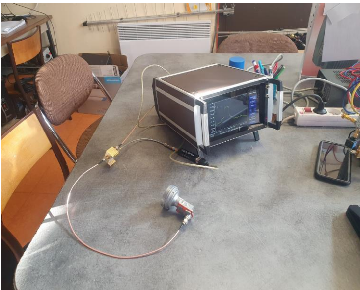
Réception : Tete RF + Splitter et Clé SDR
